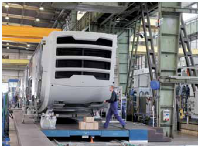
Blick in die Produktionshallen von Nordex, hier im Bild die Gondel.
