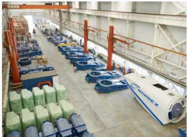
Blick in die Produktionshallen von Nordex, rechts unten im Bild eine Gondel
